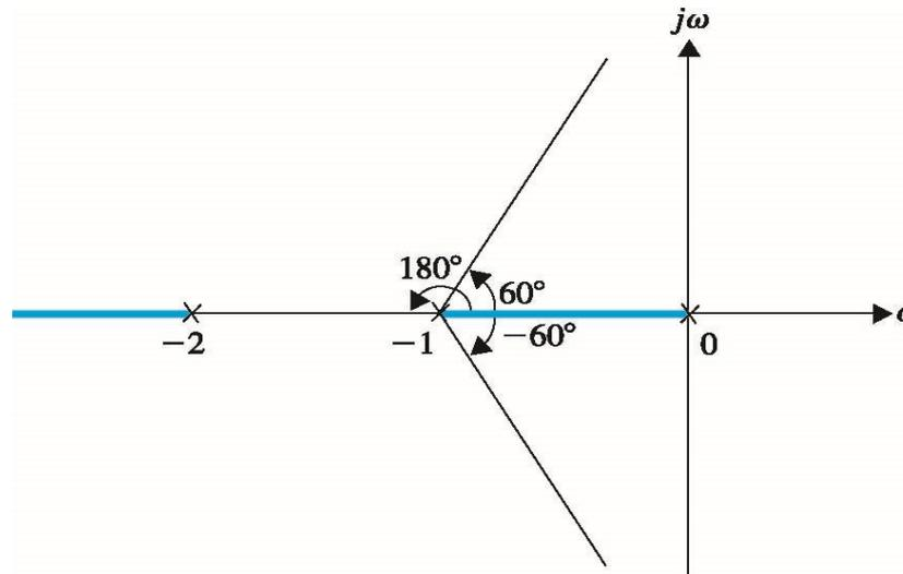
그림  $G(s) = \frac{K}{s(s+1)(s+2)}$  의 근궤적선도상에서의 점근선 표시
