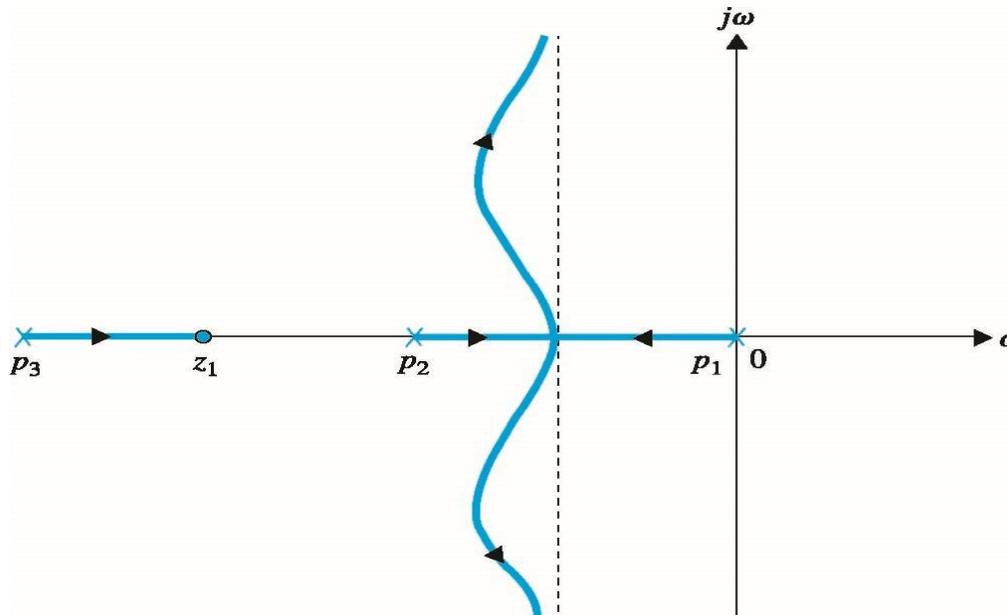
그림 소스-싱크 상사 개념을 이용하여 작도한 근궤적선도의 예
