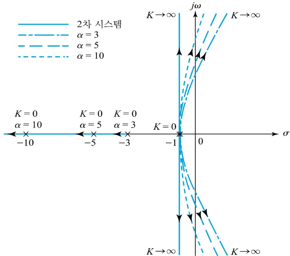
그림 5.28  $G(s) = \frac{\alpha K}{(s + \alpha)(s + 1)^2}$  인 시스템과  $G(s)$  에서  $s = -\alpha$  있는 개루프 극점이 무시된 2차 시스템에 대한 근궤적선도
