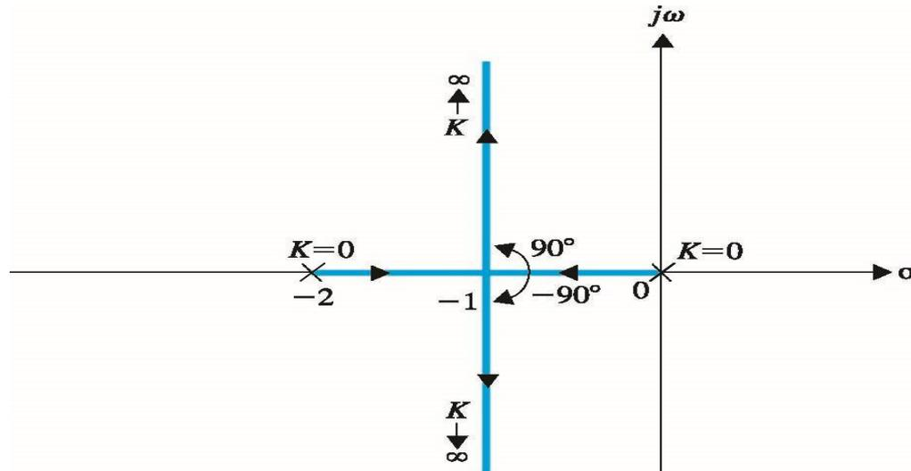
그림 시스템  $G(s) = \frac{K}{s(s+2)}$  의 근궤적선도
